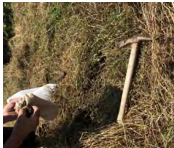
Pamje gjatë marrjes së provave gjeokimike për S. Gj. N, në toka thellësinë 50-60cm [View while taking geochemical samples for S. N. G., on soil at depth 50-60cm]
