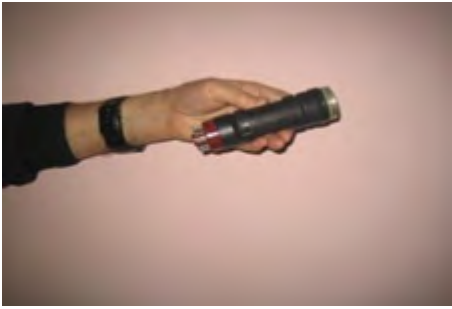
Marrësi GDB-35 + Krištali NaITl, me madhësi 1x1Inch [Receiver GDB-35 + NaITl Crystals, size 1x1Inch]
