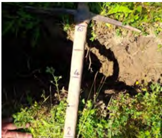
Pamje gjatë marrjes së provave gjeokimike në toka thellësinë 10-15cm [View while taking geochemical samples on soil, at depth 10-15cm]
